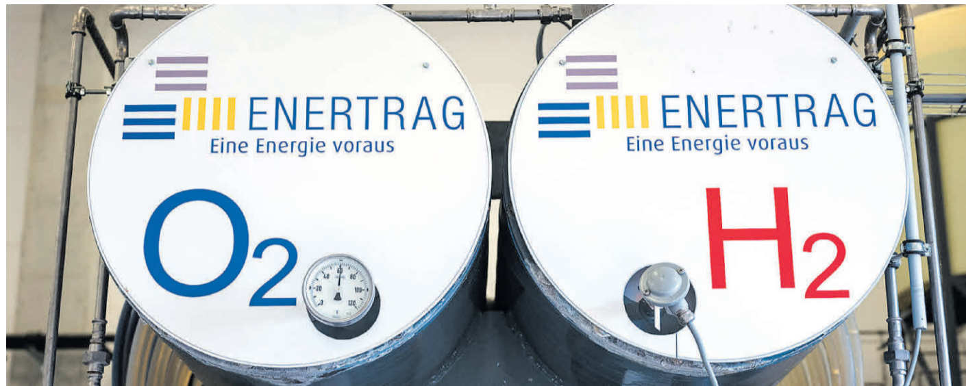
In einer Elektrolyse wird Wasser in Wasser- und Sauerstoff aufgespalten. Das Foto zeigt eine Anlage des Unternehmens Enertrag aus Brandenburg.
